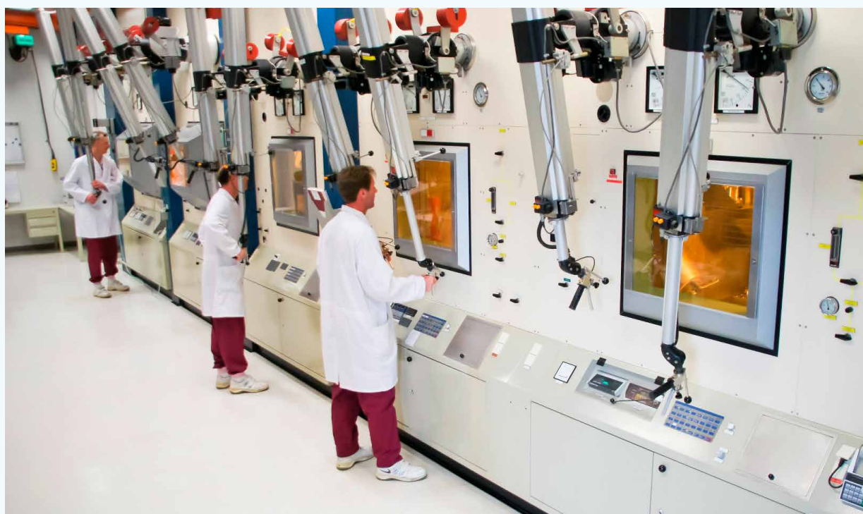
Figuur 14: Foto van een hot cell, hier wordt het molybdeen gescheiden van het restmateriaal (Bron: Curium)
