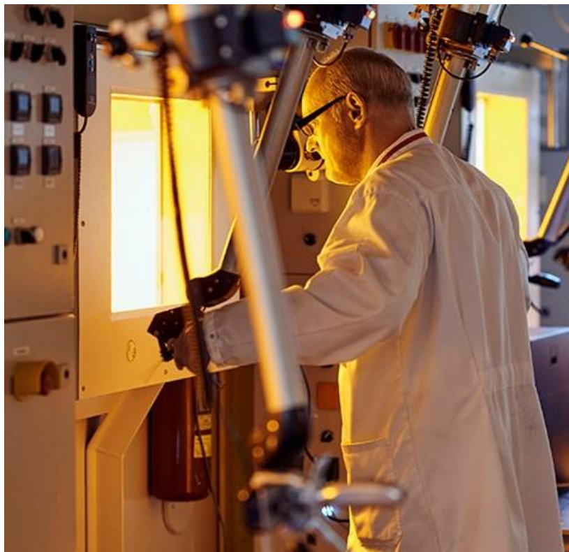
Figuur 6: Een medewerker bestuurt manipulatoren bij een hot cell.
