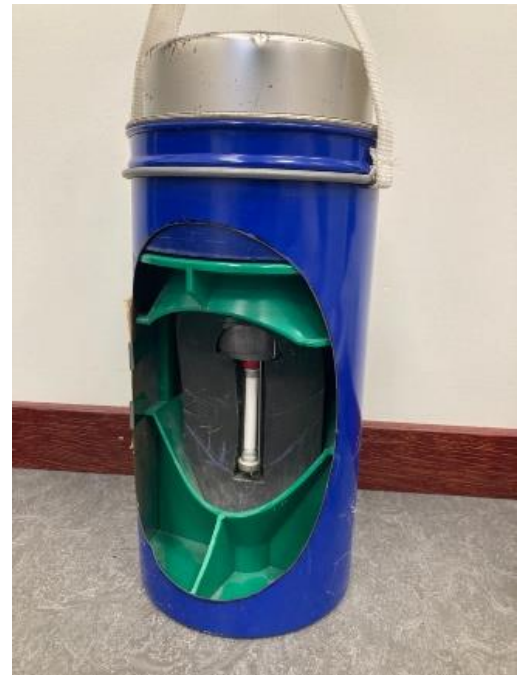
Figuur 5: Een model van een technetiumkoe. In het midden zit een buisje met het radioactieve materiaal. Daar omheen zit lood ter bescherming.
