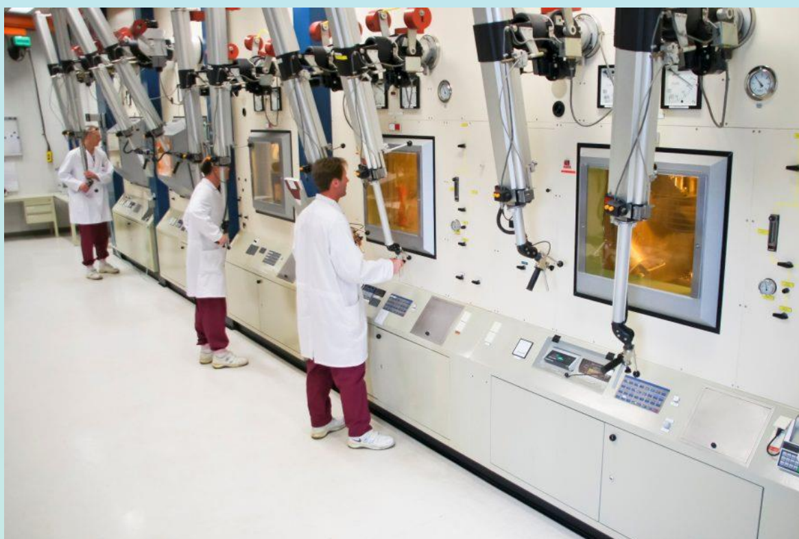
Figuur 14: Foto van een hot cell, hier wordt het molybdeen gescheiden van het restmateriaal. Bron: Curium.
