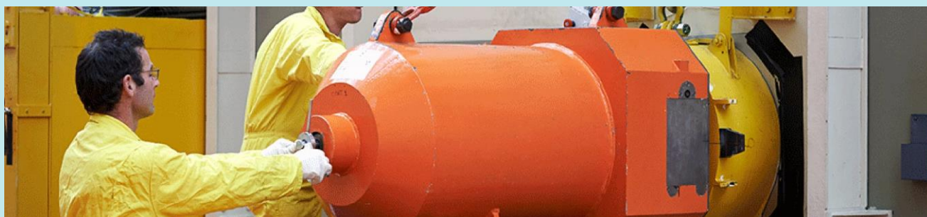
Figuur 16: Radioactief materiaal wordt in een container (oranje) geladen. Bron: nrg.eu
