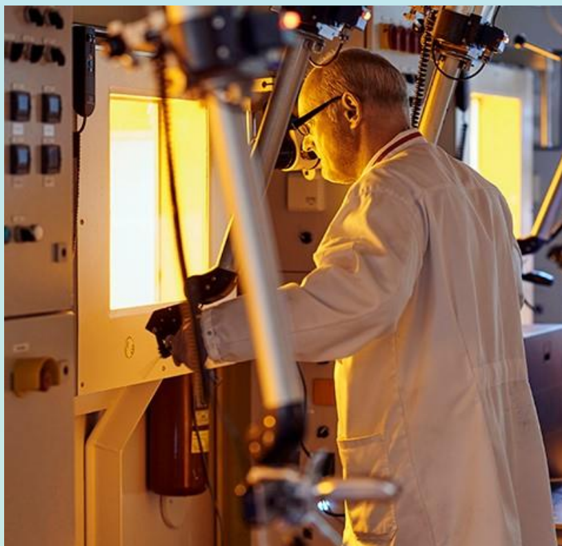
Figuur 6: Een medewerker bestuurt manipulatoren bij een hot cell. Bron: nrg.eu
